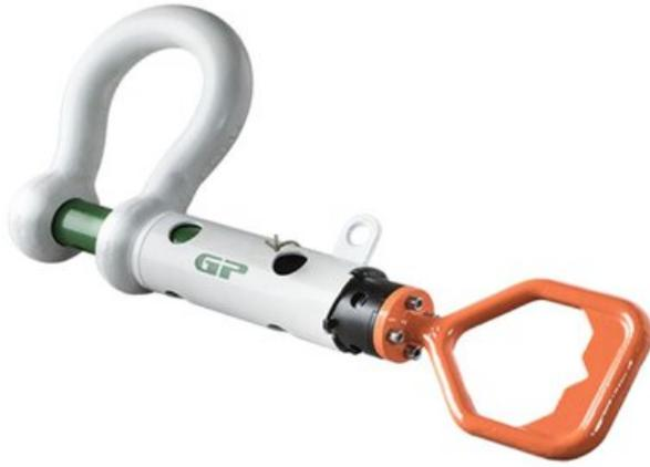
La **Manille ROV à axe guidé D** est dotée d'un tube de guidage conçu pour les opérations de largage et d'accrochage effectuées avec un ROV. Le tube de guidage garantit un alignement parfait de l'axe de la manille avec l'anneau, ce qui facilite le montage et le démontage à distance. L'anneau de levage situé sur le tube de guidage permet d'aider l'opérateur du ROV à équilibrer la manille et empêche l'axe de sortir du tube.
